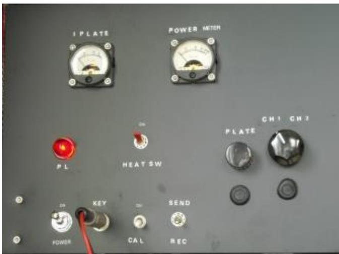
送信方法は「SEND-REC」のトグルスイッチを「SEND」側にし、「CAL」のトグルスイッチを「ON」にします。
