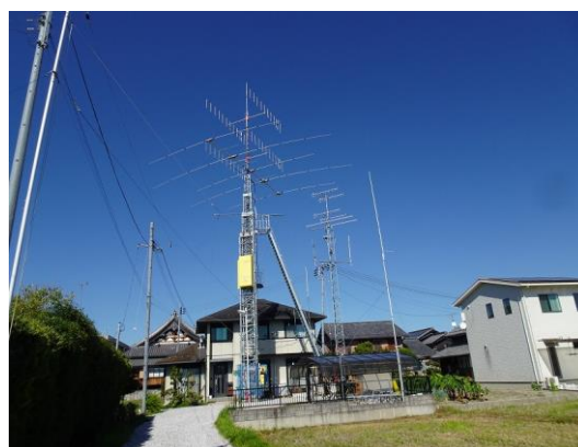
コンテストに使用したアンテナ 144 メガのスタック 2 段の下が、工人舎の複合アンテナで 50 メガは 8 エレです。
